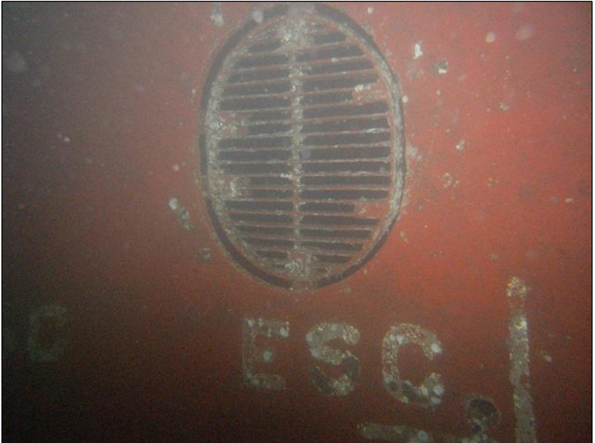
Figura 9 – “Grade da caixa de mar” de uma plataforma [Disponível em: < http://cargo-inspection.com/eg/n/1975/0/vietnam-underwater-ship-hull-cleaning.htm >. Acesso em: 17 jul. 2015]
