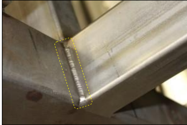
Figura 7 – “Solda de costura” unindo duas estruturas [Disponível em: < http://www.vista-industrial.com/blog/stitch-welding-vs-seam-welding >. Acesso em: 17 jul. 2015]
